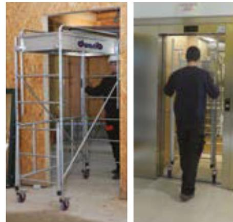
Permet de passer les portes d'une hauteur mini de 2,04 m, sans retirer le moindre élément.
