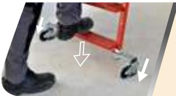
Sous le poids de l'opérateur, la plate-forme se met **SOLIDEMENT EN APPUI SUR SES PATINS.**
