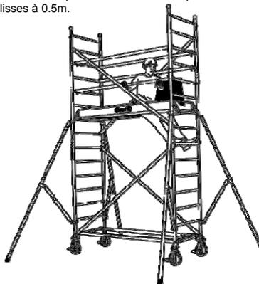
**Ne jamais monter sur un plancher sans les garde-corps à 1m**
