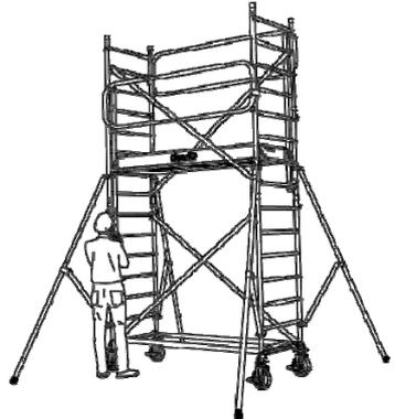
**Ne jamais monter sur un plancher sans les garde-corps à 1m**
