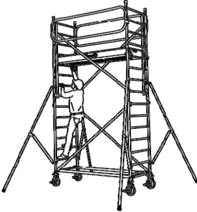
34 A la hauteur souhaitée, le plancher doit être horizontal et verrouillé.
